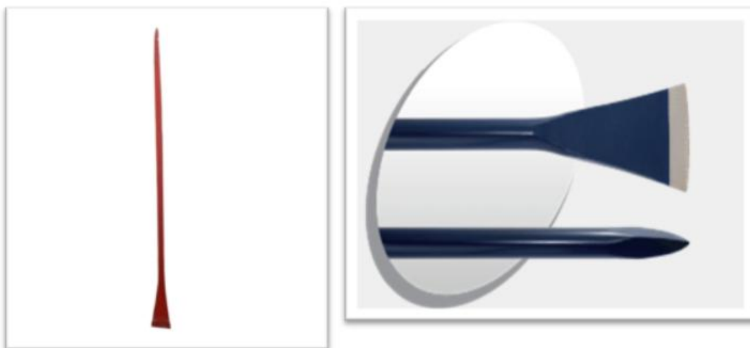
Figura 3 – Alavancas utilizadas atualmente. À esquerda uma imagem da ferramenta alavanca inteira. À direita detalhe das suas extremidades de trabalho: acima a de gume linear, e abaixo a com ponta piramidal
