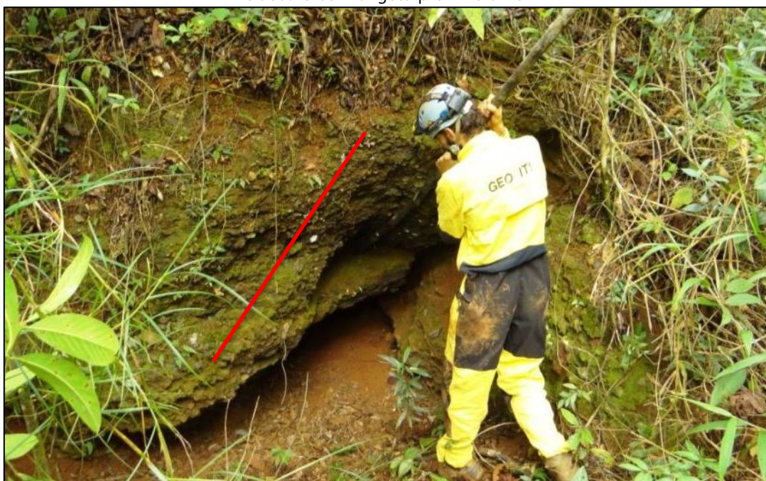
Figura 5 – Simulação de como teria sido o uso de uma alavanca na entrada de uma galeria escavada em conglomerado ferruginoso. O suporte rochoso de canga apresenta a morfologia resultante do trabalho com ângulo próximo a 45°
